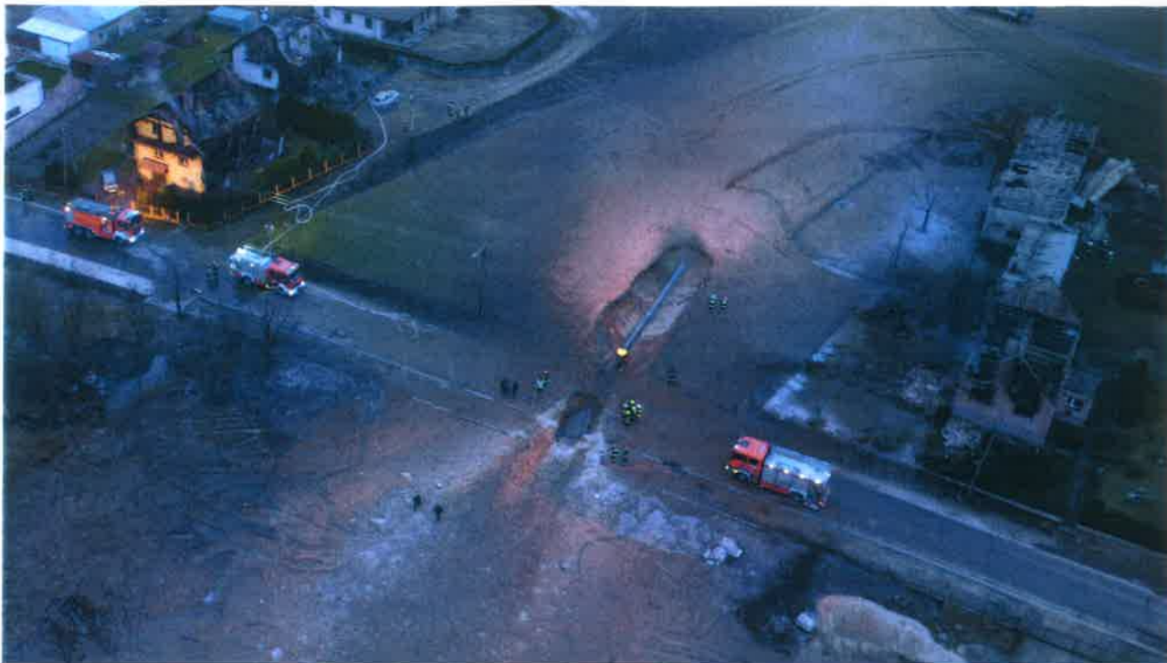
Rys. nr 7. Katastrofa budowlana gazociągu DN500 Poznań-Rogoźno, 26 stycznia 2018 r.
